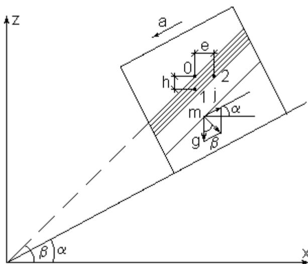
Рис. 3.1. Поступательное движение по наклонной плоскости
