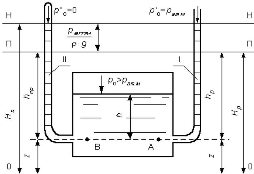
Рис. 2.7. Определение напора
