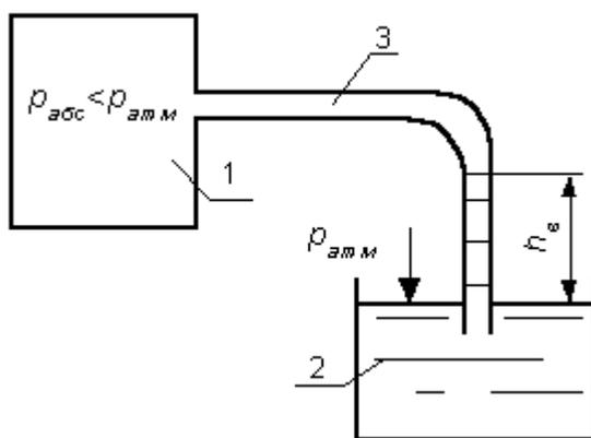
Рис.2.5. Вакуумметрическая высота
