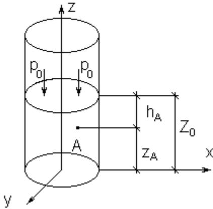
Рис. 2.2. Определение давления в точке А
