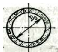
Рис. III.16. Железобетонная фальцевая труба
