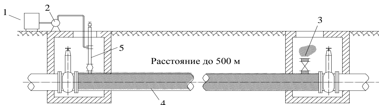
Рис.11 Схема аэрозольной дезинфекции анолитом трубопроводов с применением установки МАГ-1: 1-емкость с анолитом; 2- установка безвоздушного распыления МАГ-1; 3- выпуск воздуха; 4- трубопровод; 5-устройство ввода аэрозоля в трубопровод.
