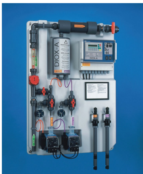
Рис. 22 Установка для получения и дозирования хлордиоксида по технологии с использованием хлорита и соляной кислоты в разбавленном растворе. Производительность установки до 250 г хлордиоксида в час.
