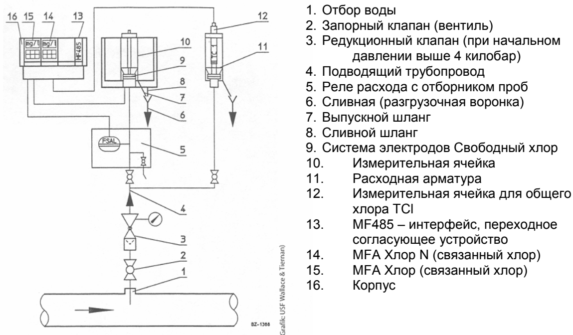
Рис. 51 Технологическая схема определения содержания свободного хлора и общего хлора в питьевой воде. Вода, подаваемая на оба измерительных прибора имеет одинаковый состав. Разница сигналов на выходе (общий хлор минус свободный хлор) покажет содержание связанного хлора на модуле (MFA Chlor N).
