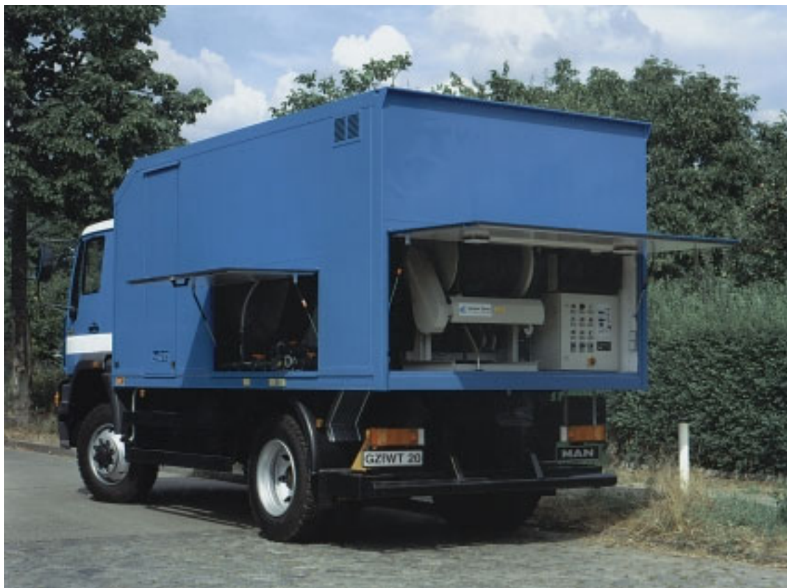
Рис.27 Передвижная установка для хлорирования водопроводных сетей, встроенная в грузовой автомобиль.
