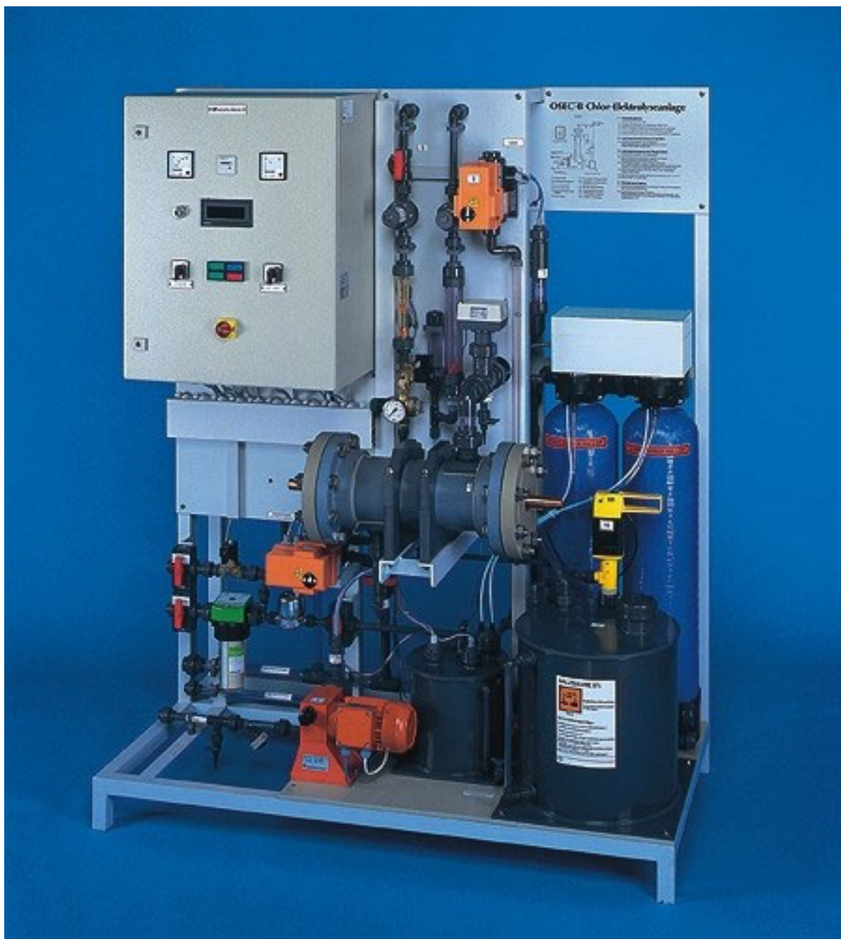
Рис. 15 Оборудование для электролиза со смягчителем воды. Очистка электродов происходит автоматически с помощью соляной кислоты
