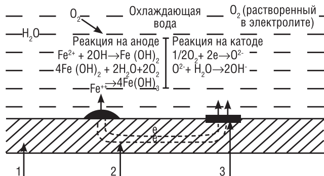
Рис. 1.24. Механизм электрохимической коррозии в системе «металл–воздух–вода»:
