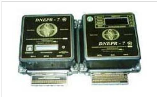
Прибор общепромышленного назначения с широким диапазоном контролируемых сред (вода: чистая, сточная, с примесями; кислоты; ацетоны; щелочи; спирты и их растворы; пар, канализационные стоки). Предназначен для измерения технологических и коммерческих значений расхода, количества жидкости и насыщенного пара. Выпускается в стационарном и портативном вариантах.
