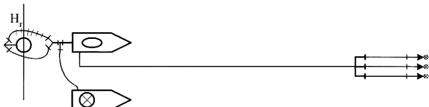
Рис. 16.10 Подача пенообразователя от АПТ в напорно-всасывающую линию от пожарного автомобиля, установленного на пожарный гидрант
