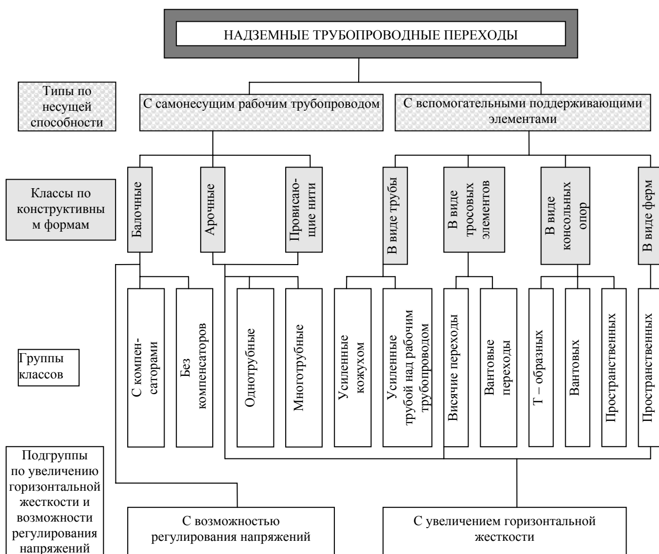
Рис.5.18. Классификация надземных трубопроводных переходов по конструктивным признакам
