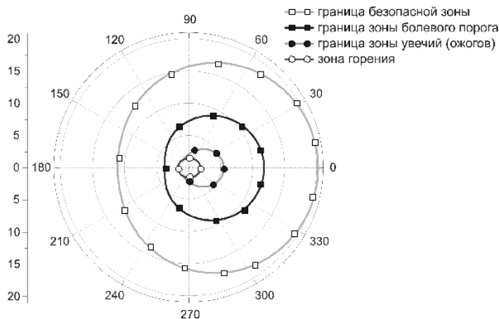
Рис. 4.20. Зоны теплового поражения пожара разлития
