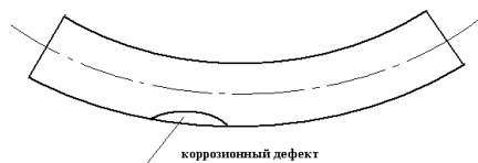
Рис. 3.24. Схема отвода с дефектом на внешней стороне
