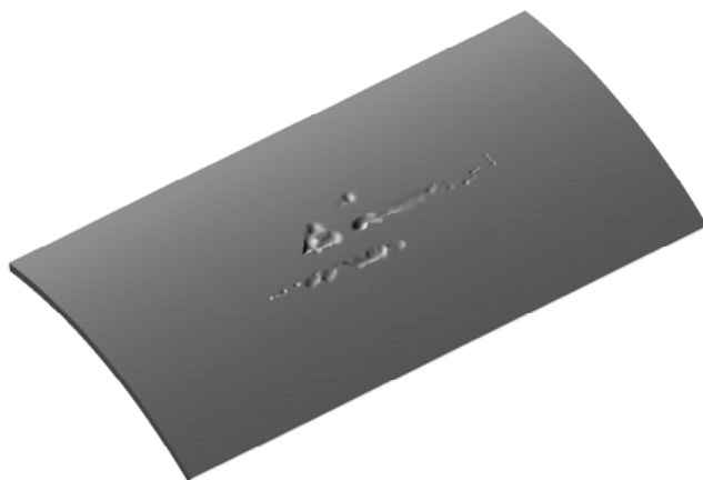
Рис. 3.17. Расчетная модель участка трубопровода с коррозионными дефектами
