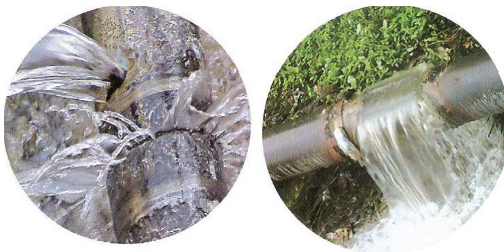
Fig. 5.17. - Găurirea peretelui tubului
