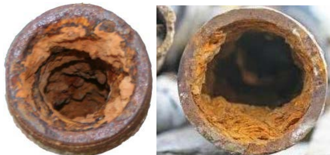
Fig. 5.26. – Interiorul unor tuburi încrustate
