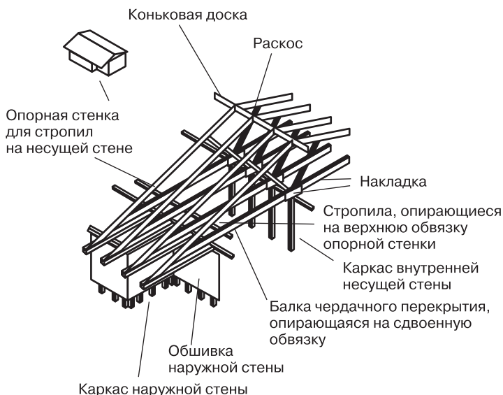
Рис. 4.25. Устройство каркаса скатной крыши при смещенной внутрь дома наружной стене
