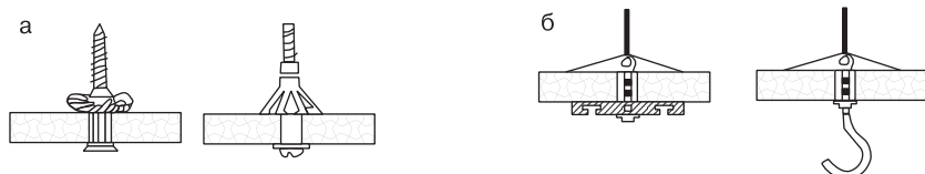
Рис. 5.6. Разжимающиеся дюбели (а) и проходные анкера (б) для крепления к обшивке подвесного потолка светильников, штор
