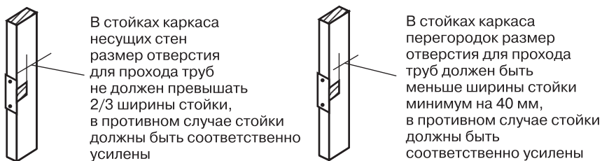
Рис. 4.45. Вырезы в стойках каркаса для прохода труб
