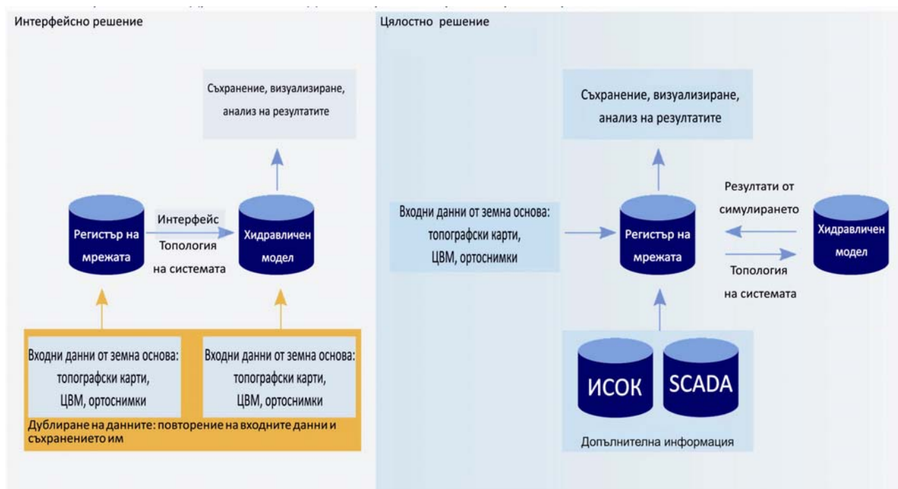
Фигура 5.4 Свързване на хидравличния модел на мрежата с регистъра на мрежата
