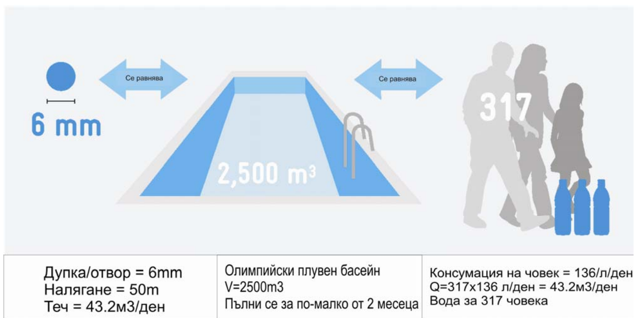
Фигура 2.2 Дебит на теч при единичен отвор от 6 mm и еквивалентен обем вода
