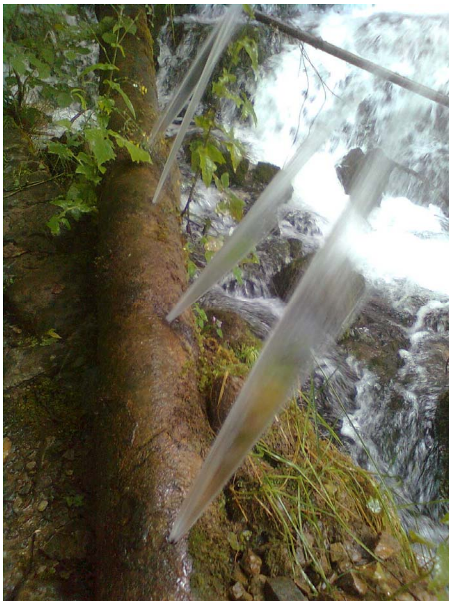
Фигура 3.8 Пробиви по амортизирана тръба
