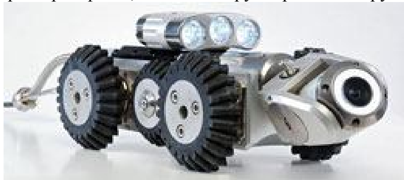
Рис. 4. Робот с телекамерой
