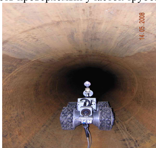
Рис.5. Телеробот в инспектируемой трубе
