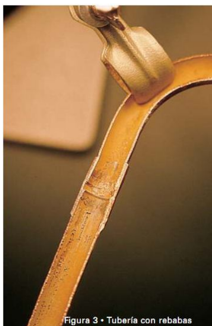
Figura 3 • Tubería con rebabas
