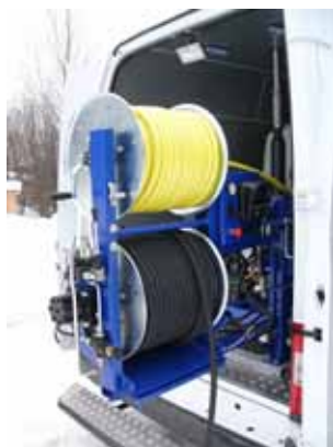
VHT150/100 НА АВТОМОБИЛЕ FORD В УТЕПЛЕННОМ ОТАПЛИВАЕМОМ КУЗОВЕ С ОТСЕКОМ ДЛЯ ПЕРСОНАЛА (РАБОТА ДО -25°)
