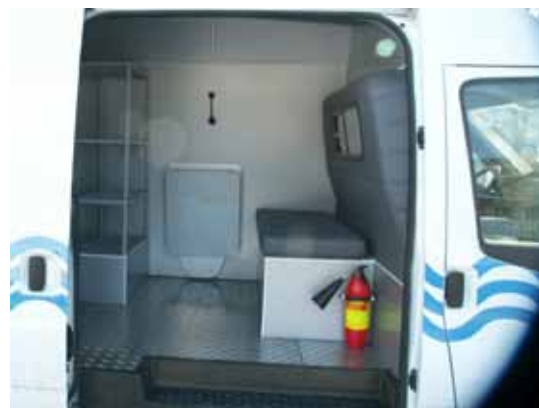
VHT150/100 НА АВТОМОБИЛЕ FORD В УТЕПЛЕННОМ ОТАПЛИВАЕМОМ КУЗОВЕ С ОТСЕКОМ ДЛЯ ПЕРСОНАЛА (РАБОТА ДО -25°)
