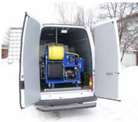
VHT150/100 НА АВТОМОБИЛЕ FORD В УТЕПЛЕННОМ ОТАПЛИВАЕМОМ КУЗОВЕ С ОТСЕКОМ ДЛЯ ПЕРСОНАЛА (РАБОТА ДО -25°)
