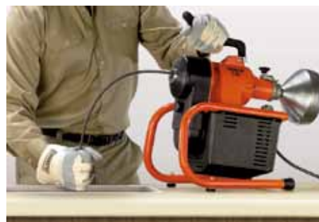
РАБОТА С МАЛЫМ БАРАБАНОМ СО СПИРАЛЬЮ 8ММ
