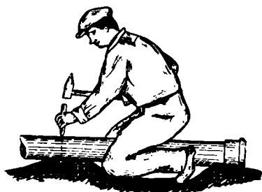
Fig. 21. Așezarea tubului pentru tăiere.
