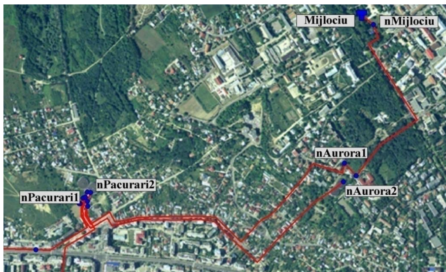
Figura. 3. Modelarea sistemelor Păcurari, Aurora și Mijlociu pentru simularea curgerii gravitaționale
