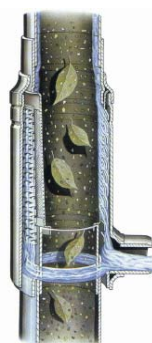
D. Filtru colector auto-curățitor, (montat la baza burlanelor)
