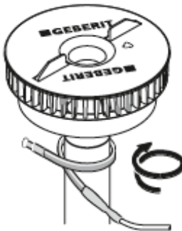
Fig. 7.16 - Element de încălzire receptor cu guler de formă circulară și cu rezistență electrică de încălzire pentru evitarea pericolului de îngheț
