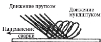
Рис. 101. Сварка ванночками
