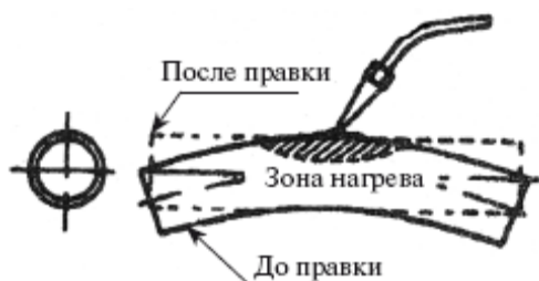
Рис. 103. Правка изделий местным нагревом
