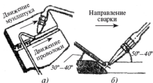
Рис. 100. Правая сварка: а – схема движения мундштука и горелки; б – углы наклона мундштука и проволоки
