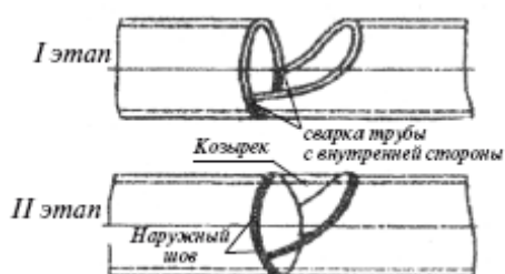
Рис. 109. Порядок сварки стыков труб с козырьком
