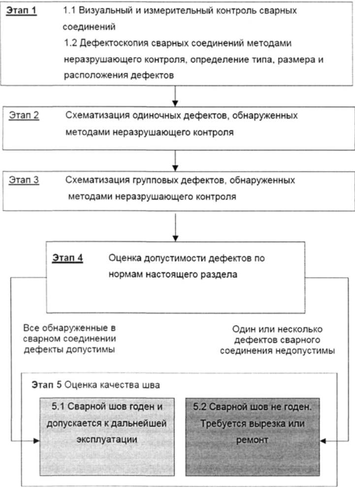
Рисунок 3 - Алгоритм оценки качества кольцевых сварных соединений газопроводов, находящихся в эксплуатации
