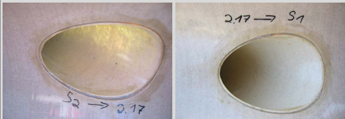
Bild 216: Belastung: 50 Zyklen-kein Splitt-D1 (8x30°)
