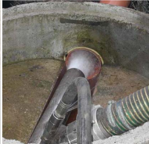
Schwalldüse nach dem Ejektorprinzip
