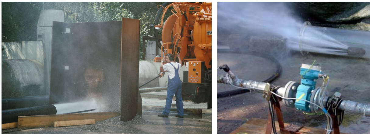
Bild 60: Einsatz von HD-Spülfahrzeugen im Versuch (links); Messung der Betriebsparameter (Druck und Durchfluss) mit MID-Durchflussmessgerät und Druckaufnehmer (rechts)
