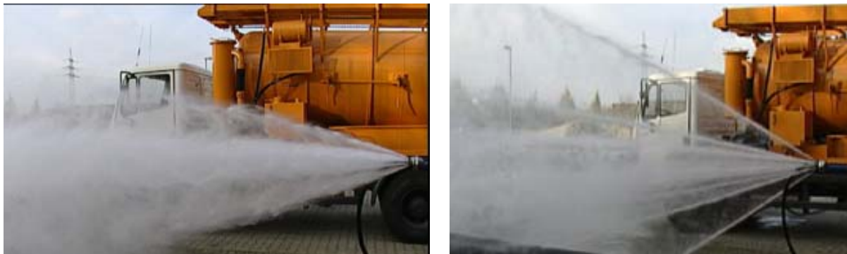
Bild 82: Vergleichende Betrachtung der Strahleigenschaften von HD-Düsen, Beispiele: aufgefächerte Einzelstrahlen (links), kompakte Einzelstrahlen (rechts)
