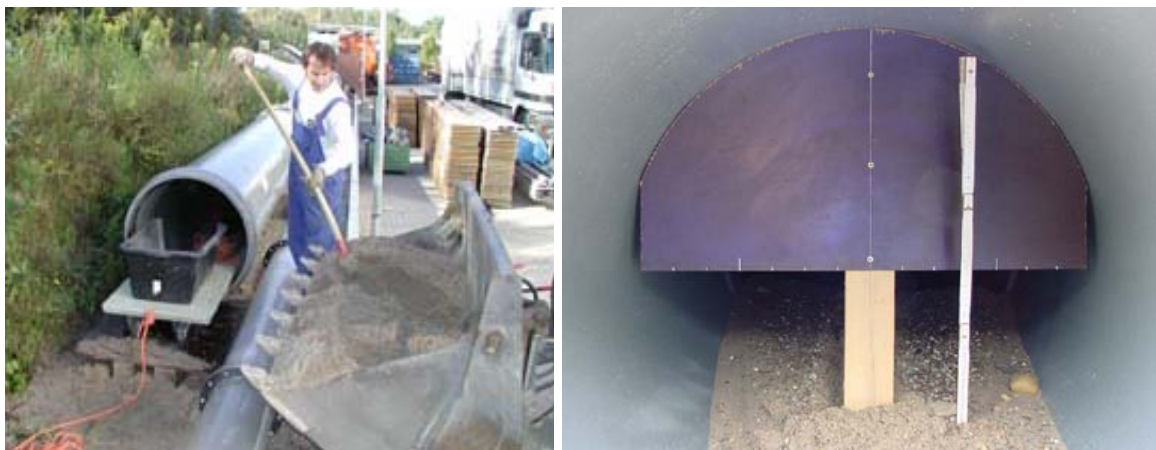
Bild 59: Versuchsstrecke DN 800: Befüllen der Versuchsstrecken mit Modellsedimenten (links), Füllstandskontrolle (rechts)
