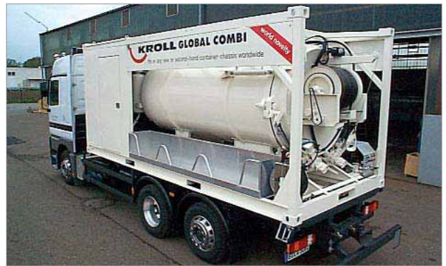
Установка на базе контейнера
