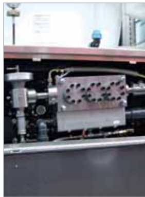
Насос сверхвысокого давления (1500 бар)
