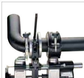
Соединение труба/фитинг с узким и широким зажимами
