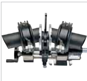
Благодаря двухсторонней градуировке основных зажимов (15° в обе стороны) можно изготавливать отводы
