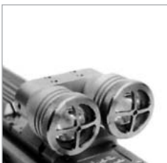
Доп. освещение для робота FW 150 ED2
