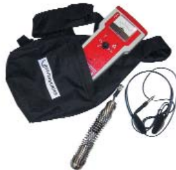
Определение местоположения камеры по звуковому сигналу и показаниям прибора
