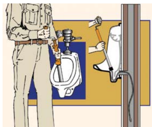
Прочистка засора писсуара
