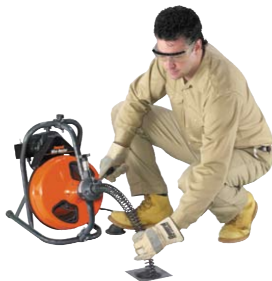
Очистка слива (с устройством автоподдачи спирали –PO-MR). Оператору управляет скоростью подачи спирали
