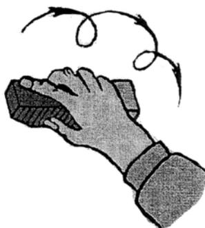
**Рисунок 13 – Шлифовка прошпатлеванных мест поверхности стен**
