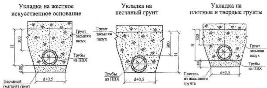
Рисунок 9 - Схемы укладки труб из ПВХ в грунте
