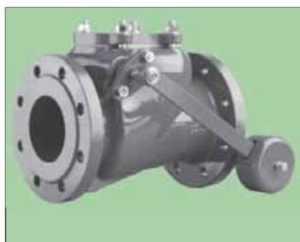
VAG RSK Обратный клапан AL Вода Ру 10/16 - Ду (DN) 40...250 металлическое уплотнение - с рычагом и противовесом
