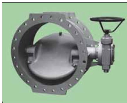
VAG EKN® Поворотной затвор, сварной из стали Вода Ру 6/10/16/25/40 - Ду (DN) 150...4000 длинная строительная длина - эпоксид
