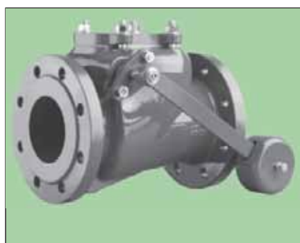
VAG RSK Обратный клапан AL Вода Ру 10/16 - Ду (DN) 40...250 мягкое уплотнение - с рычагом и противовесом
