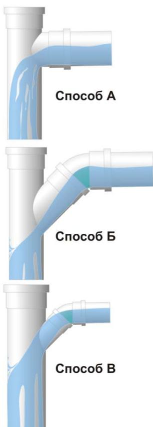
Способ А: Тройник с углами от  $87^\circ$  до  $88,5^\circ$  – самое распространенное и рекомендуемое решение, поскольку улучшает циркуляцию воздуха, поддерживает низкую скорость стока и обладает низким уровнем шума по сравнению с другими.
