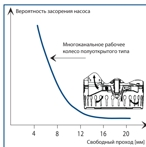
Рис. 1 Вероятность засорения насоса в зависимости от значения свободного прохода насоса. Для исключения засорения насоса значения свободного прохода должен составлять 10 – 12 мм.
