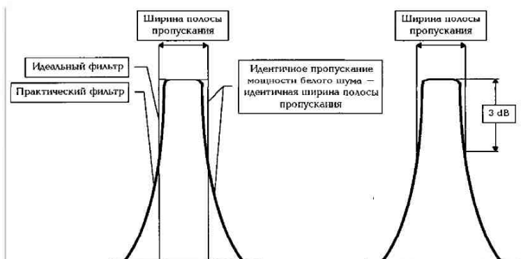
Рис. а2—08. Эффективная ширина полосы пропускания на основе мощности белого шума (слева) и ширина полосы пропускания на уровне 3 дБ (справа).
