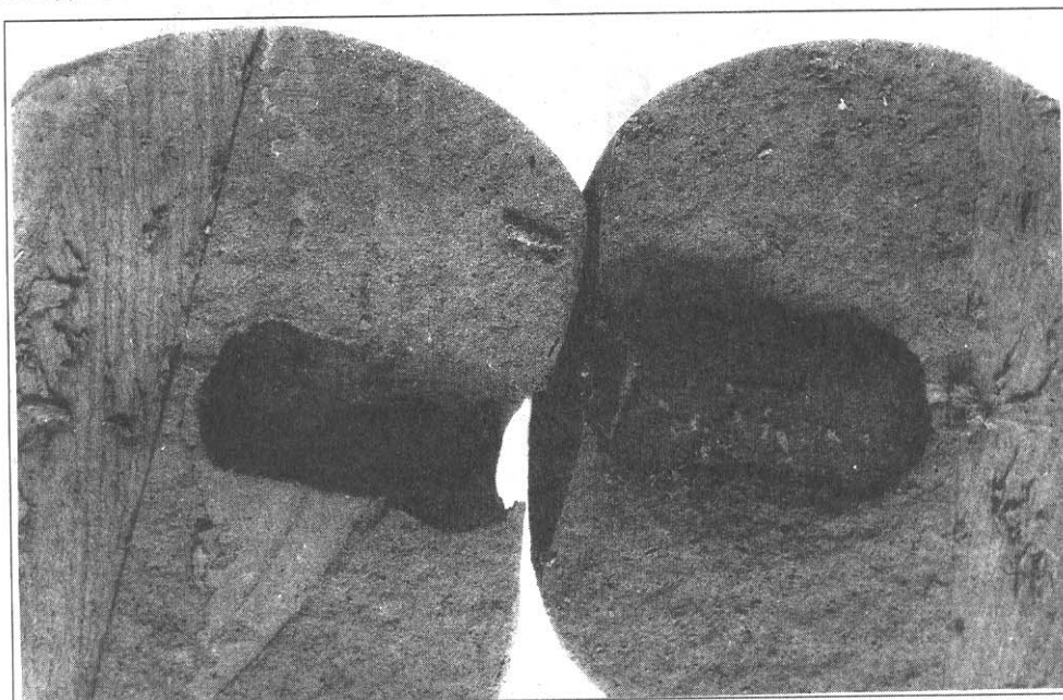
Рис. 6.35. Образец загустевшего и уменьшившегося за счет отсоса воды бурового раствора из скважины, введенного в цементный (температура 75^\circ\text{C} , 2 сут твердения)
