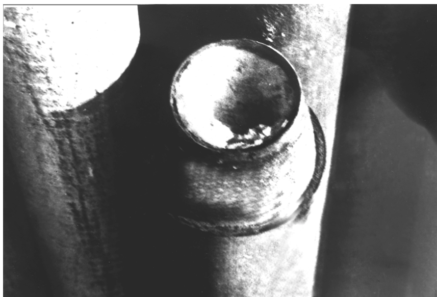
Рис. 6.23. Канал в цементно-глинистом растворе, затвердевшем в трубах в скважине
