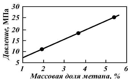
Рис. 6.3. Изменение растворимости метана в буровом растворе на нефтяной основе с ростом давления
