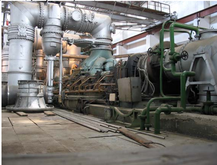
Рисунок 3 - Фотография организации подачи воды на входе в компрессор
