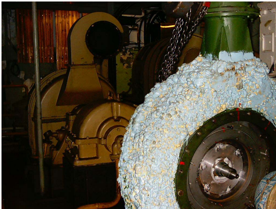
Рисунок 3 - Экспериментальный стенд ЭЦК-4 для модельных испытаний центробежных компрессорных ступеней (проточная часть модельной ступени демонтирована)
