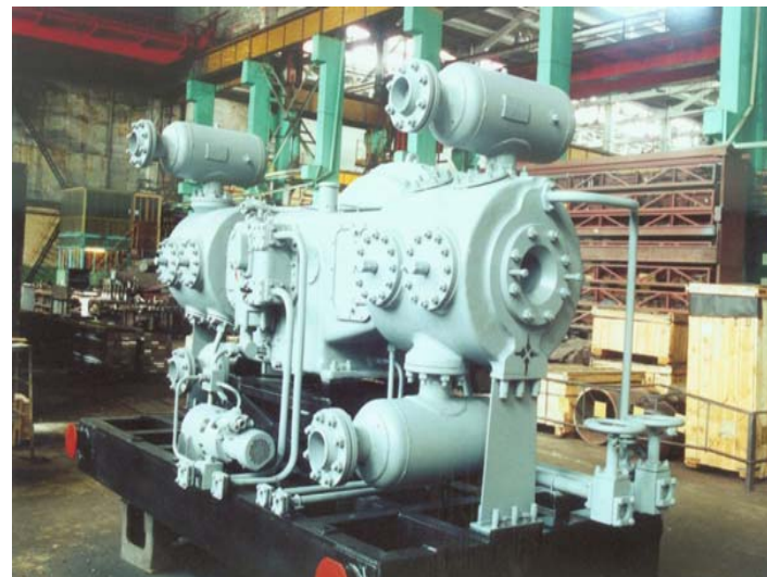
Рисунок 7 - Один из первых образцов поршневых компрессоров на базе М4 (2ГМ4-10,6/15-24С) без смазки цилиндров и штоковых уплотнений
