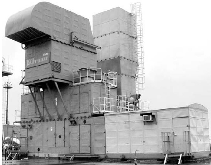
Рисунок 1 - Газоперекачивающий агрегат нового поколения с авиаприводом типа ГПА-Ц-6,3 МВт
