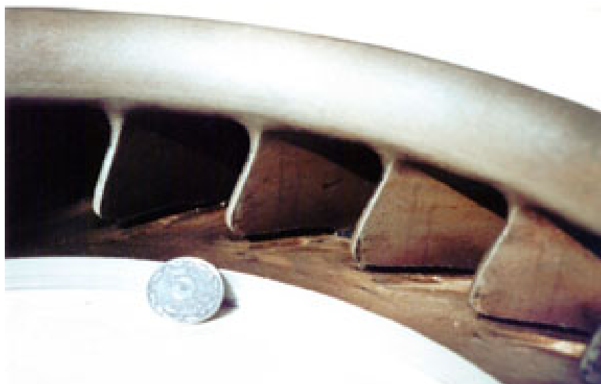
Рисунок 3 - Эрозионный износ лопаток колеса 1-й ступени ротора воздушного компрессора КВД модели 2MCL - 456 фирмы "Хитачи" (Япония)
