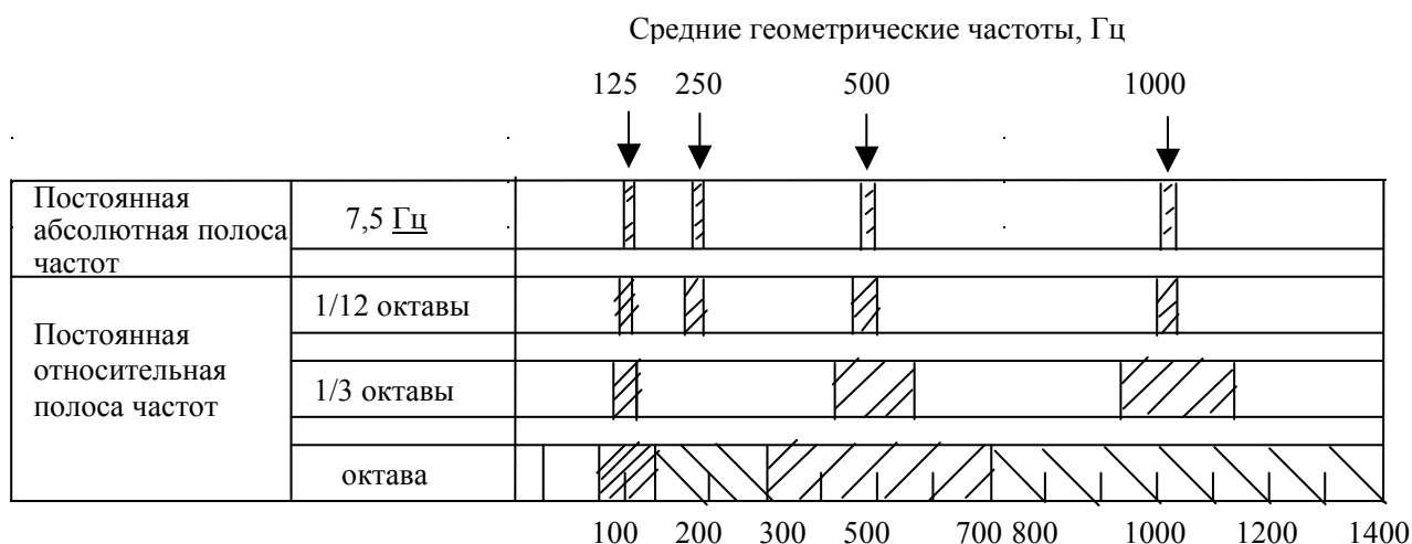
Рис. 1.8. Эффективность ширины полос для различных областей частот
