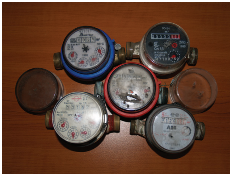
Рис. 1. Несанкционированные воздействия через пластмассовый колпак счетчика.
