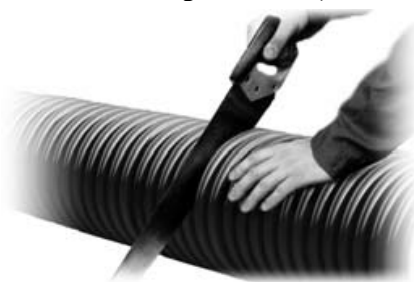
Рисунок 9.20 – Резка ТПСС (стенка из двух слоев – гофрированный наружный и гладкий внутренний слои) плотницкой ножовкой (выкопировка из ТУ 2248-004-50049230-2006 [10])
