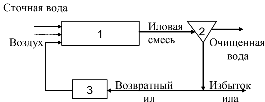
Рис. 43. Принципиальная схема установки биоочистки с аэротенком: 1 – аэротенк; 2 – вторичный отстойник; 3 – регенератор
