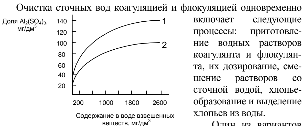
Рис. 15. Зависимость дозы коагулянта от содержания в очищаемой воде взвешенных веществ: 1 – тонкодисперсная взвесь; 2 – грубодисперсная взвесь
