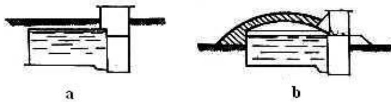
Fig.4.10 – Rezervoare de ap a – îngropat; b – semiîngropat
