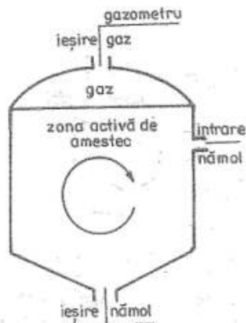
Figura 9.8. Instalație de fermentare de mare încărcare
