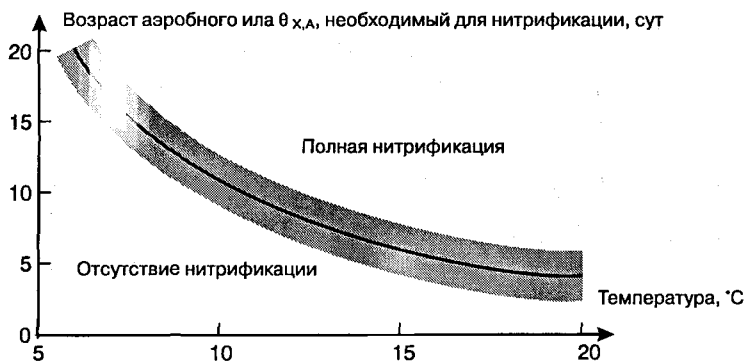
Рис. 6.2. Соотношение между температурой и необходимым возрастом аэробного ила для процесса нитрификации в системе с активным илом. Концентрация кислорода 2 \text{ г/м}^3 . При более высоких концентрациях растворенного кислорода кривая располагается ниже.
