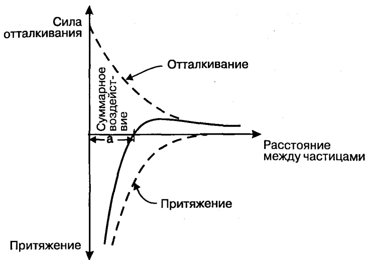
Рис. 10.12. Взаимодействие между частицами как функция расстояния между ними [4]. Если расстояние между частицами меньше, чем a , притяжение преобладает и возможно образование первичных частиц.
