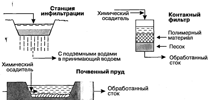
Рис. 10.20. Методы доочистки, позволяющие получить низкую концентрацию фосфора на выходе.
