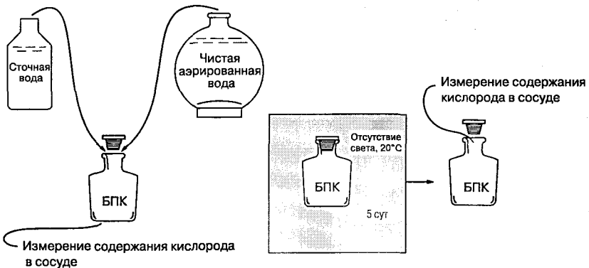
Рис. 2.5. Принцип определения БПК [12]. Обычные городские стоки необходимо разводить чистой водой примерно в 100 раз. Изначально анализ БПК не предназначался для использования при проектировании очистных станций. Тем не менее он интенсивно применяется именно в этих целях, даже несмотря на то, что в более современных подходах к проектированию, например с использованием компьютерных моделей, все чаще начинают прибегать к фракционированию ХПК.
