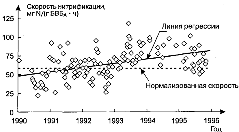
Рис. 11.5. Нормализация процесса нитрификации на пилотной установке. Благодаря усилиям, направленным на снижение ингибирующего влияния промышленных стоков, скорость нитрификации достигла и превзошла нормализованное проектное значение [6].
