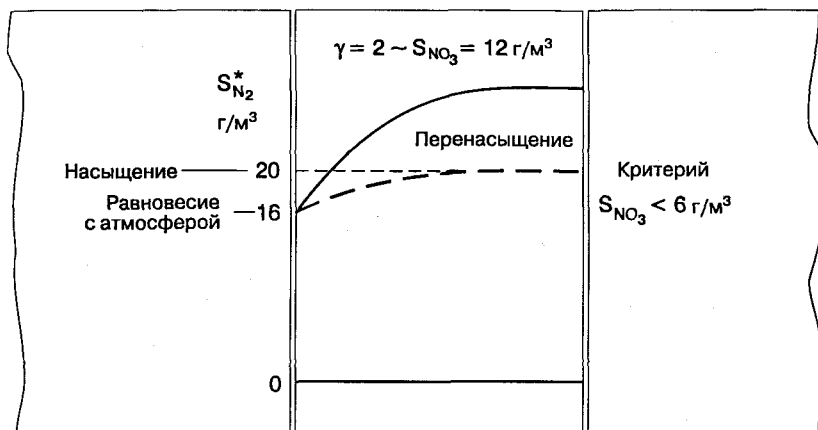
Рис. 7.21. Распределение концентрации растворенного азота в денитрифицирующей биопленке. Поверхность раздела находится в равновесии с внешней средой. При концентрации нитрата в толще воды выше, чем 6 \text{ г NO}_3^- - \text{N}/\text{м}^3 , происходит перенасыщение [8].
