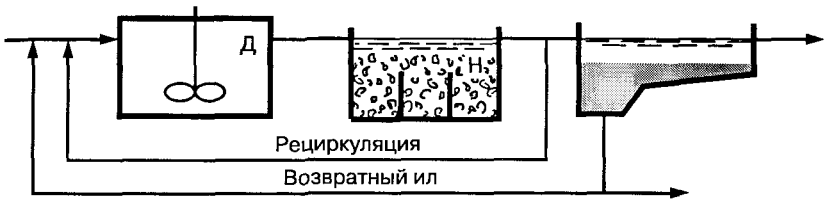
Рис. 7.12. Предденитрификация с рециркуляцией.
