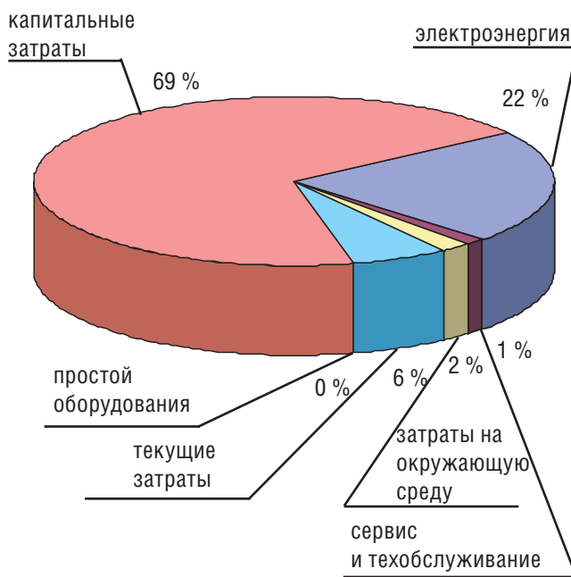
Рис. 12. Новое строительство объекта. Затраты жизненного цикла LCC блока биологической очистки с удалением азота и фосфора, где: 1 — затраты на электроэнергию (13 479 591,72 руб.); 2 — затраты на простой оборудования (0,00 руб.); 3 — затраты на сервис и техобслуживание (476 482,85 руб.); 4 — затраты на окружающую среду (1 179 027,35 руб.); 5 — текущие затраты (3 553 440,00 руб.); 6 — капитальные затраты (41 023 478,00 руб.).
