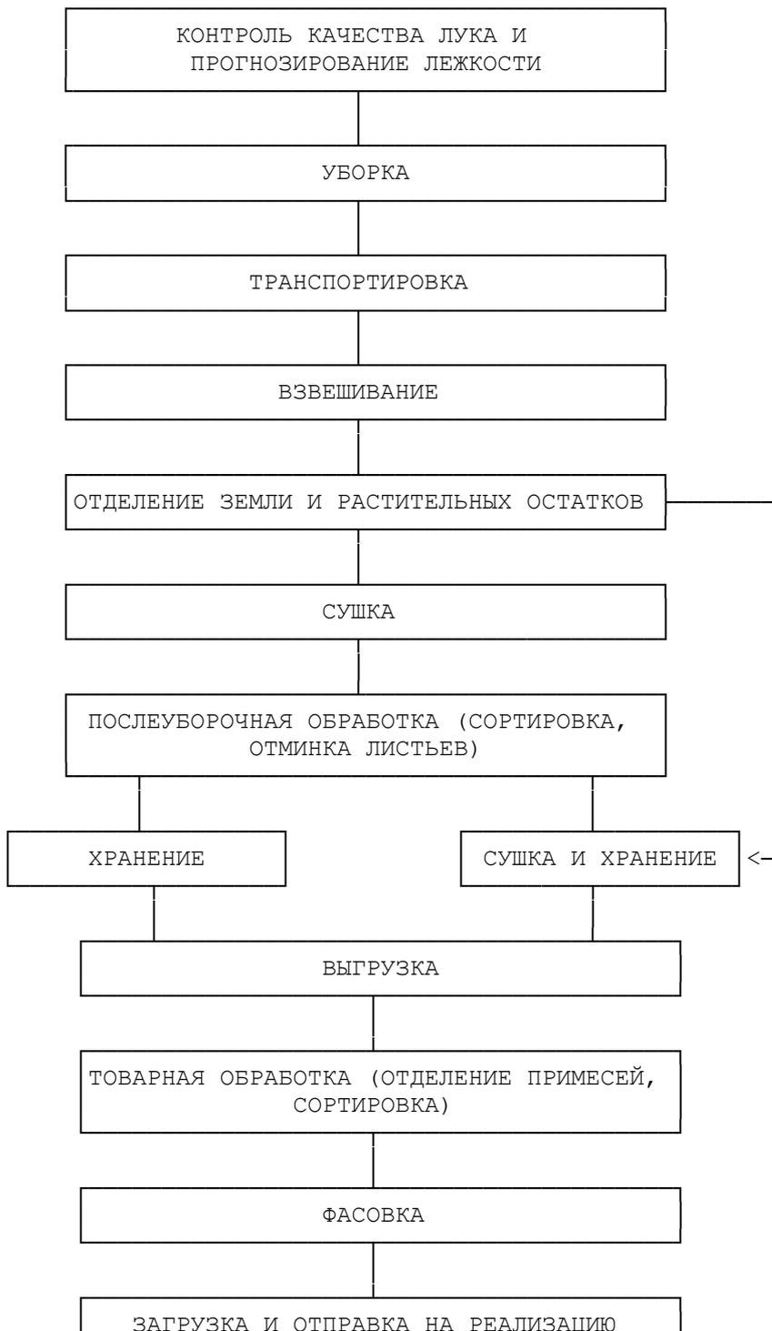
Б.8. ТЕХНОЛОГИЧЕСКАЯ СХЕМА ХРАНЕНИЯ
