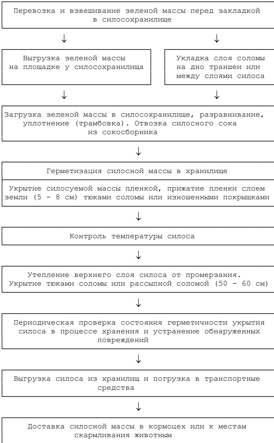
Б.2. Схема технологического процесса приготовления и хранения комбисилюса
