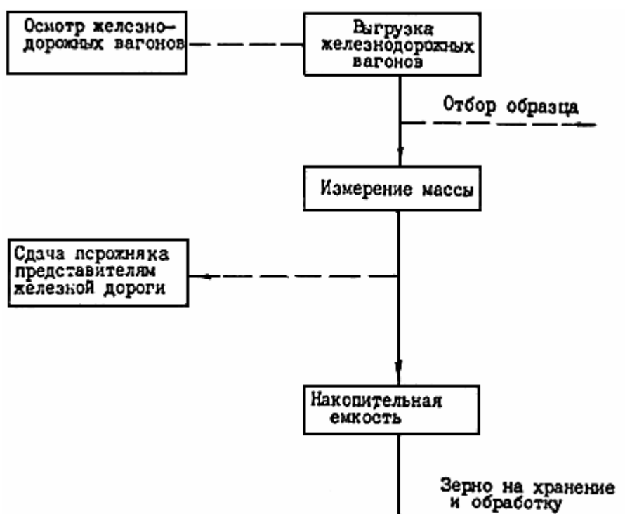
Рис.8. Принципиальная технологическая схема процесса разгрузки железнодорожных вагонов, (рекомендуемая).
