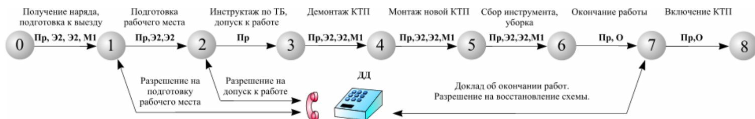
Рис.15. График выполнения работ
